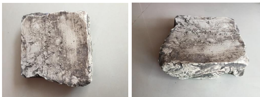
Figura 58 – Tijolo cozido feito com a mesma argila de assentamento das alvenarias
